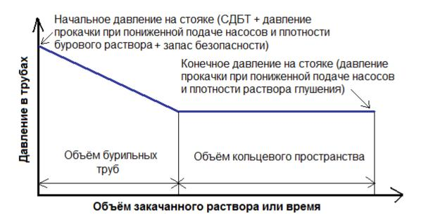
Давление прокачки при пониженной подачке насосов должно фиксироваться на буровой перед каждым интервалом бурения. Если давление на буровой не определялось, то его значение рассчитывается.
